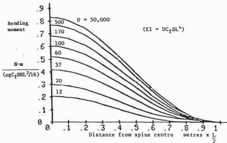
FIGURE 2 BENDING MOMENT ALONG THE SPINE FOR A RANGE OF STIFFNESSES
